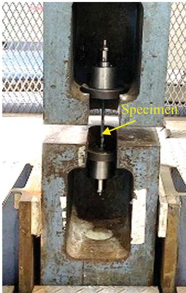
Fig. 12. Fatigue test.
